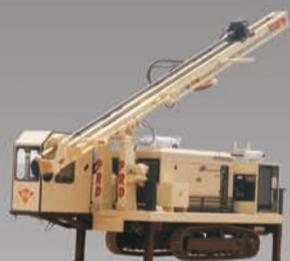
BLAST HOLE DRILL RIG
